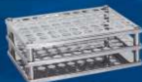
437 Stalak za 70 epruveta Ø14, H=65mm
